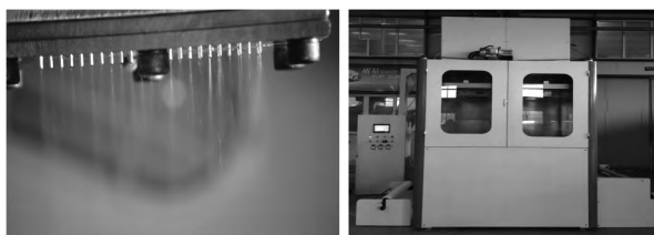
(a) 多针头溶液喷射纺丝模头 (b) 实验室用溶液喷射纺丝设备
