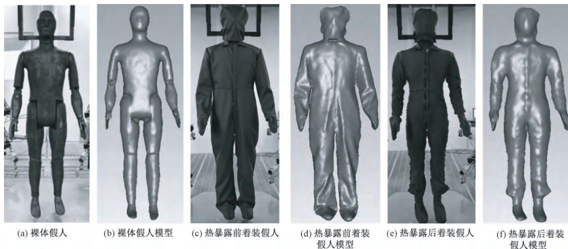
图 4 燃烧假人照片及三维重建模型
