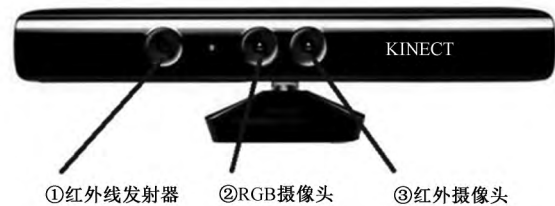
图 1 Microsoft Kinect 的构成
