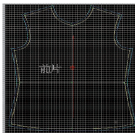
图8 绣花软件的单针勾出的样板和净样板的轮廓线
