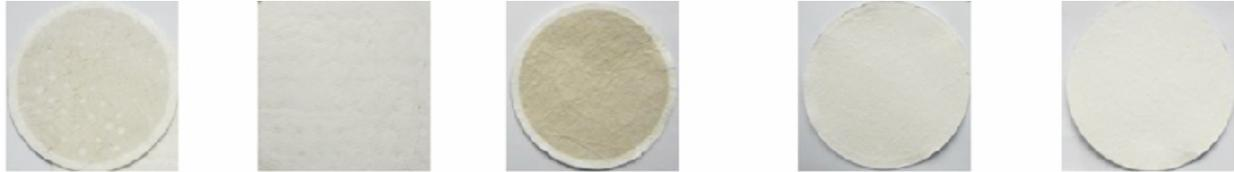
(a) 过滤后的复合滤材 (b) 过滤前的复合滤材 (c) 直接过滤后的滤膜 (d) 加入复合滤材防护层过滤后的滤膜 (e) 洁净滤膜
