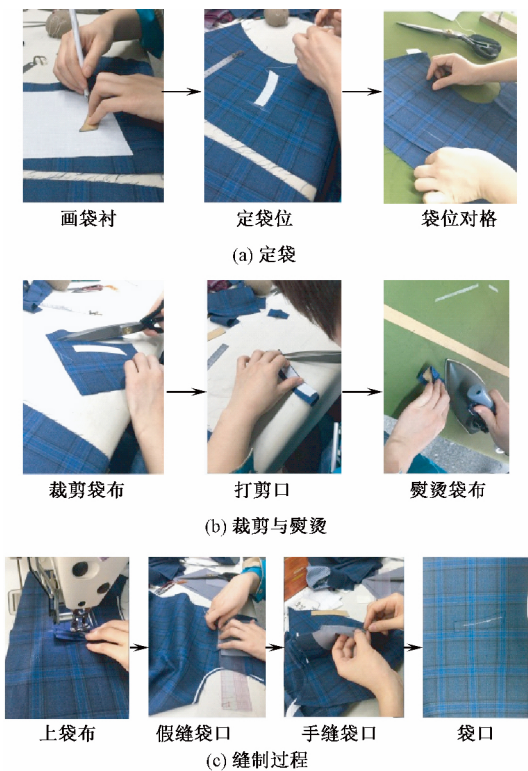
图3 船型手巾袋对条格及制作过程图
