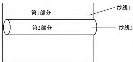
图1 局部管状织物结构图
