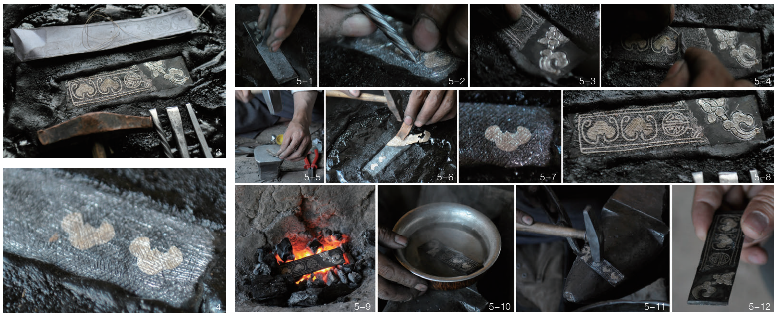
3. 布纹镶嵌工艺——主要工具 4. 布纹镶嵌工艺——银片
