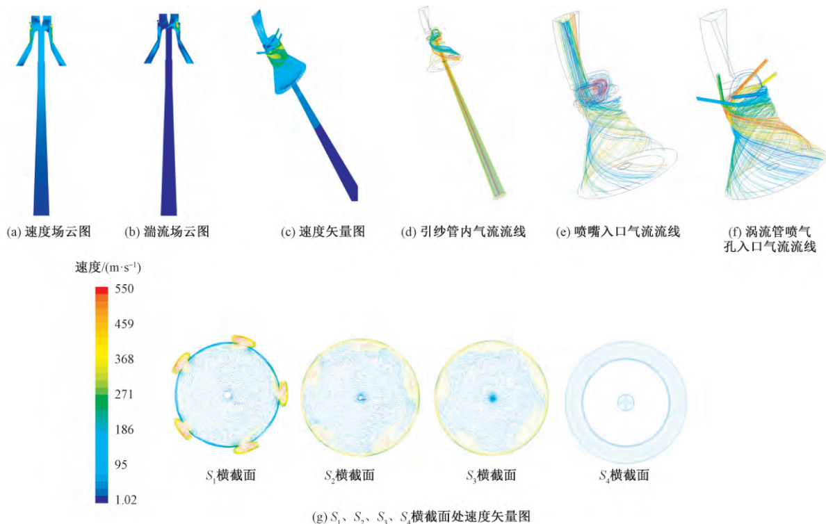
图 5 正常纺纱过程中的气流场模拟结果
